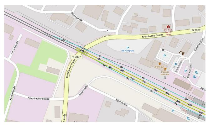
Westlich der Unterführung Krumbacher Straße ist eine Verbreiterung der Bahnschneise im Bereich Dammstraße-Ferrumgelände mit entsprechendem hohen Schallschutz erforderlich. Durch die projektierte Geschwindigkeit (300 km/h) bleibt trotzdem eine starke Beeinträchtigung der Wohnqualität für die unmittelbaren Anrainer bestehen.
