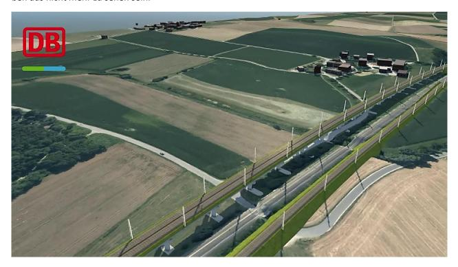
Für das Viadukt ist Lärmschutz erforderlich, sodass von einer Höhe des Bauwerks von 8 bis 10 Meter ausgegangen werden muss.
